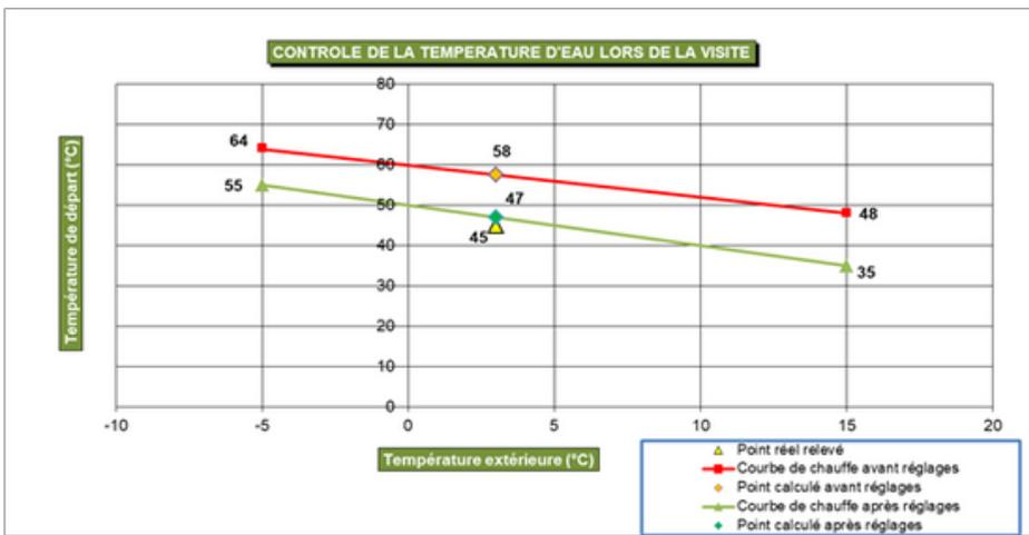
Graphique montrant l'optimisation de la loi d'eau sur l'un des circuits de chauffage de l'établissement (Circuit Sud-Ouest)
