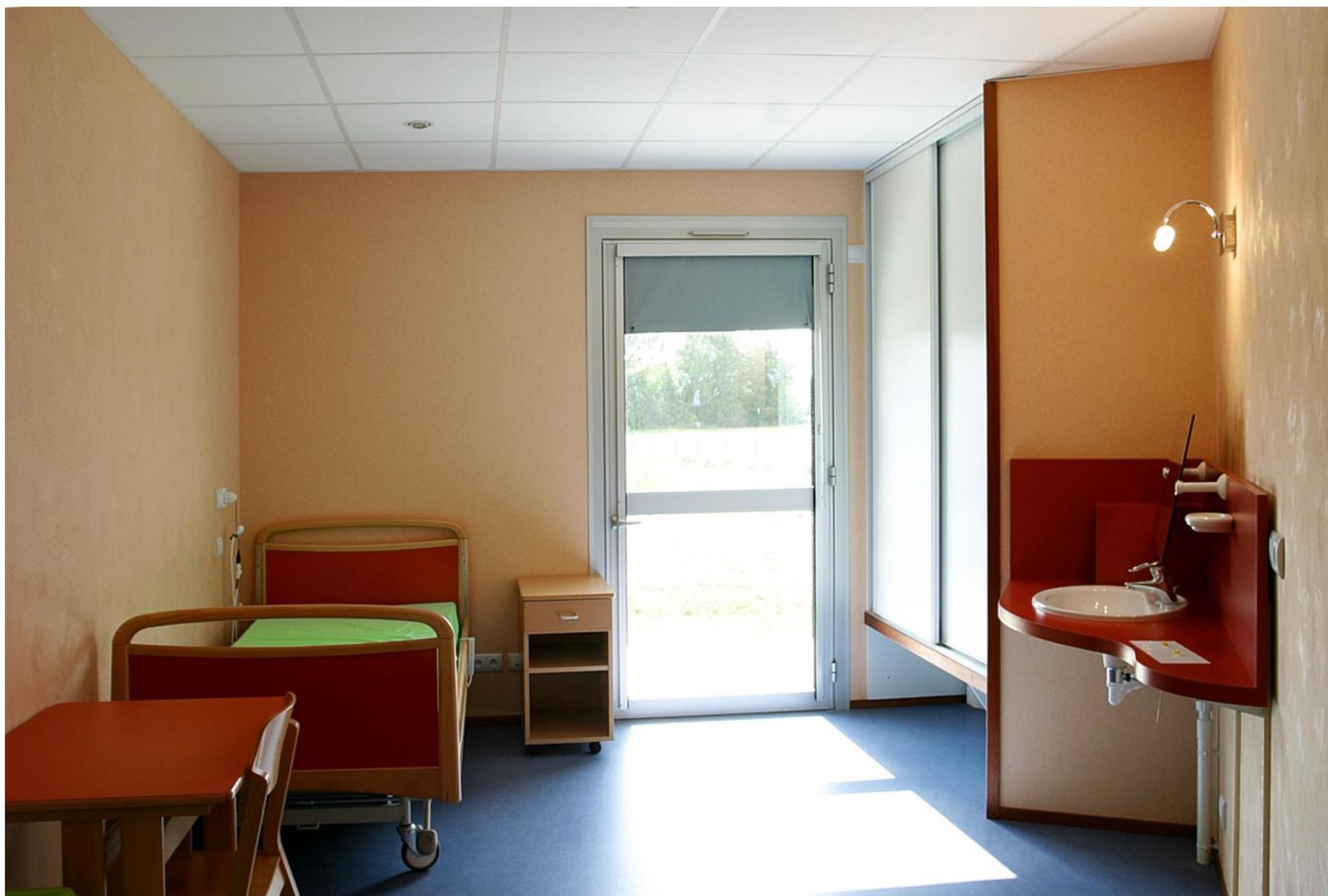
Une vasque sur pailasse et crédence colorée, réglable en hauteur avec un système low-tech, facilement appropriable par l'atelier de maintenance et les ergothérapeutes. Et une jolie lampe au-dessus.. Un placard avec plancher décollé de 40 cm du sol pour passer les cales-pied du fauteuil 😊
