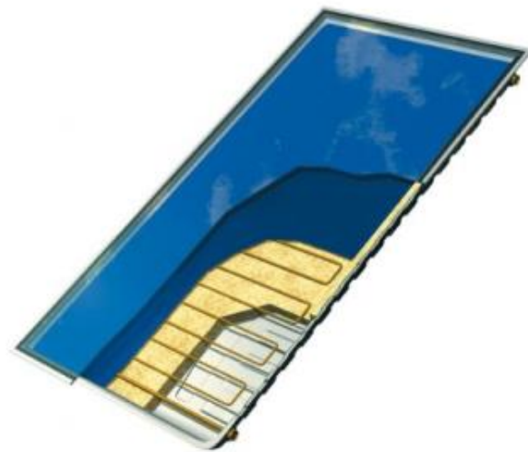
Coupe d'un panneau solaire thermique
