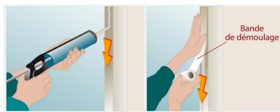
Figure 3: Pose d'un joint de silicone
