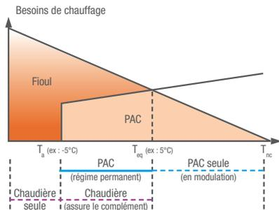
Répartition du chauffage entre la PAC et la chaudière (cas d'un montage en relèvement de chaudière)
